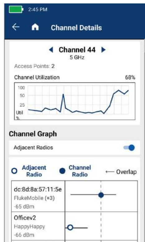
Links: Nutzung jedes Kanals auf der 5-GHz-Bandbreite mit Anzeige der jeweiligen APs und Überschneidung. Rechts: Die Details eines einzelnen Kanals zeigen die Auslastung im Laufe der Zeit und Details zu den Funkgeräten, die sich mit diesem Kanal überschneiden.
